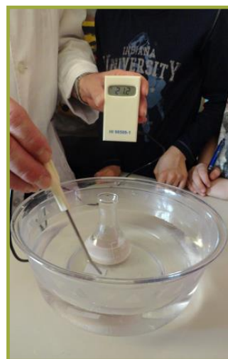
Si misura la temperatura dell'acqua di rubinetto fredda. Pian piano si raggiunge la temperatura d'equilibrio.
